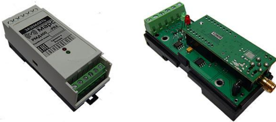
Рис.5 Внешний вид радиомодема РМД400-PR4.
