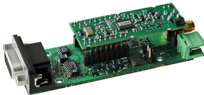
Рис.2 Внешний вид радиомодема РМД400-UP0
