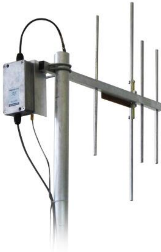
Рис.19 Монтаж радиомодема РМД400-1-SP5 на антенной мачте с помощью монтажного комплекта
